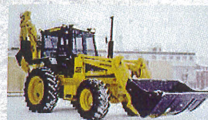
Moderne gravelaster: Hymas H52 var en fin, norsk-produsert entreprenørmaskin. Motor og bakaksel ble hentet fra hyllene til Ford.
