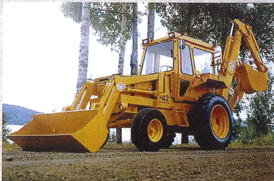
En slager: Hymas 42 var en gravelaster levert med motor/bakaksel fra flere traktorfabrikker. Modellen sto på programmet i nesten ni år.
